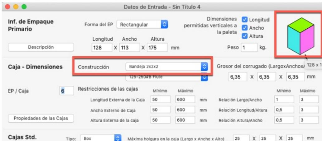
Vaya a **Recalcular** del menú **Herramientas**. En la ventana de **Soluciones disponibles** verá la lista de paletas con diferentes arreglos. Puede hacer clic en los dibujos de la paleta y de la caja para cambiar las vistas.
